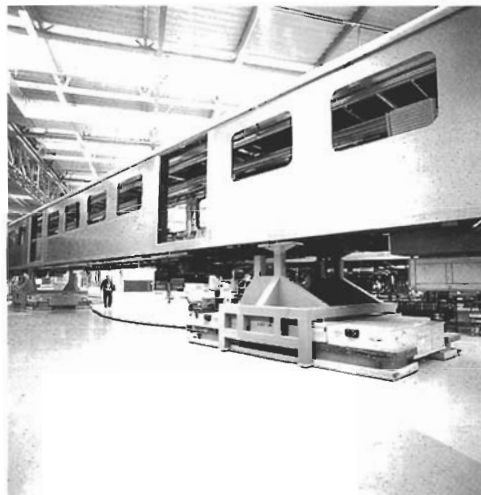
Bild 2: Transport von Wagenkästen mittels Luftkissen
